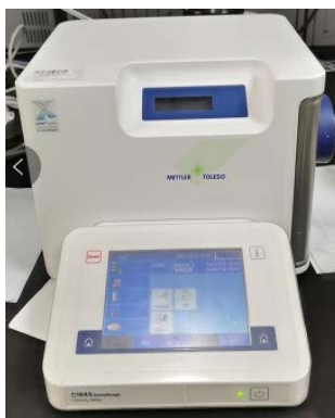
图 1 U 型管振荡法密度测量仪器
